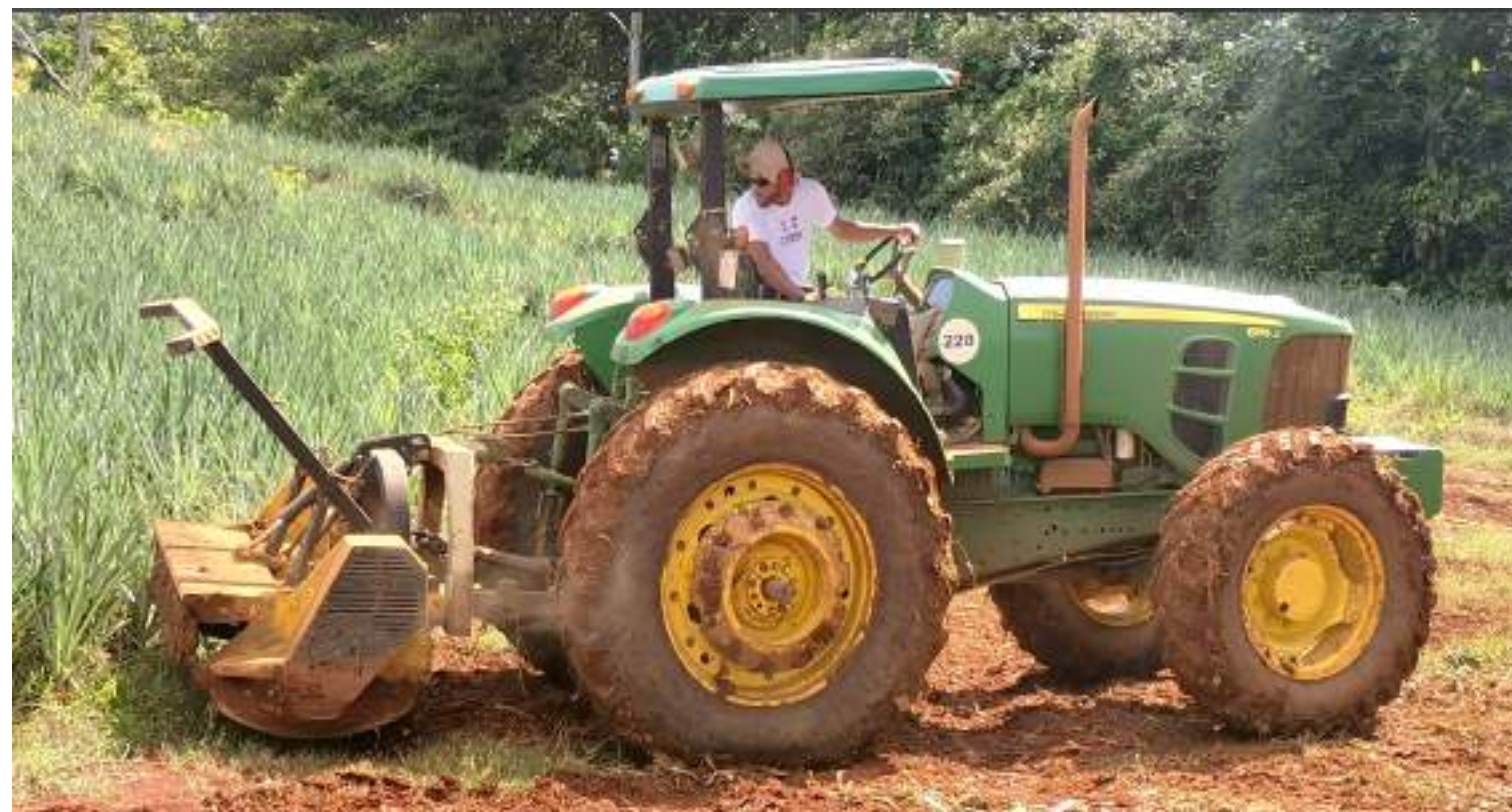
Equipo de trituración de rastrojo. Upala Agrícola, 2022
