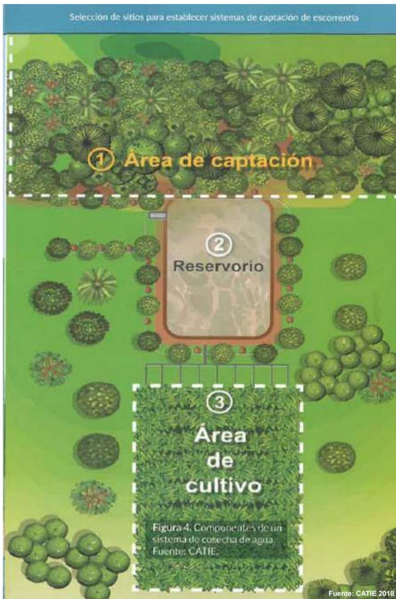
Figura 4: Componentes de un sistema de cosecha de agua.
