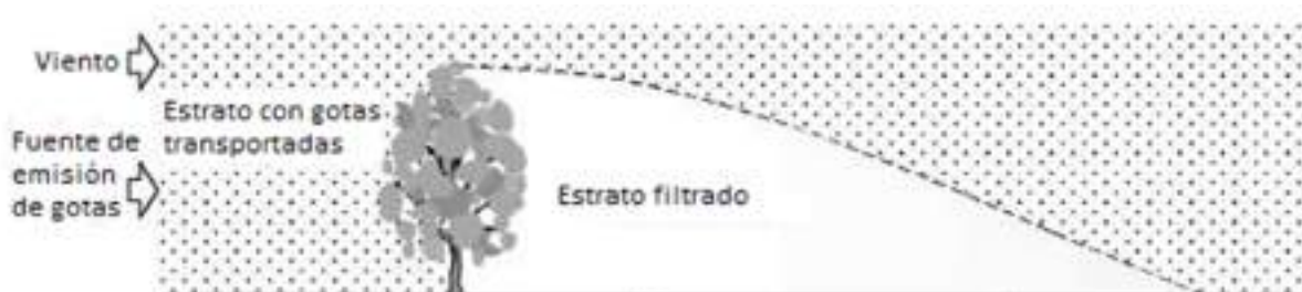
Figura 3. Corriente de aire pasando a través de una barrera
